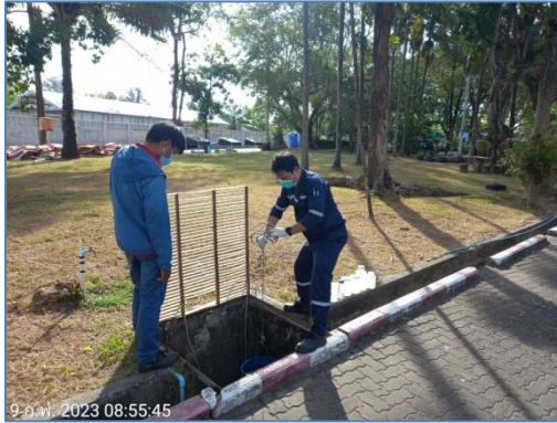
รูปที่ 3.1 บ่อพักน้ำทิ้งก่อนระบายออกจากโครงการ
